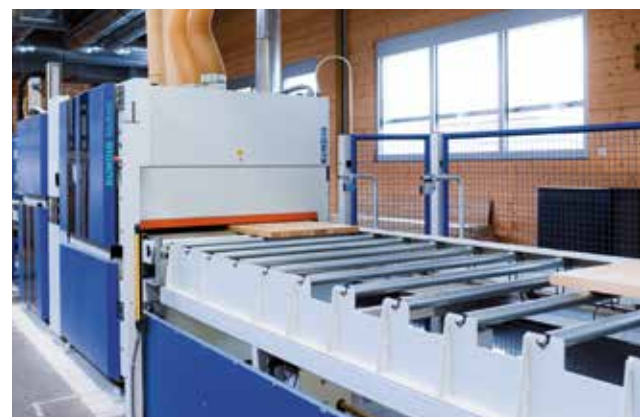
Der Einlauf der im Pressentakt ankommenden Platten wird von Sensoren automatisch kontrolliert.
