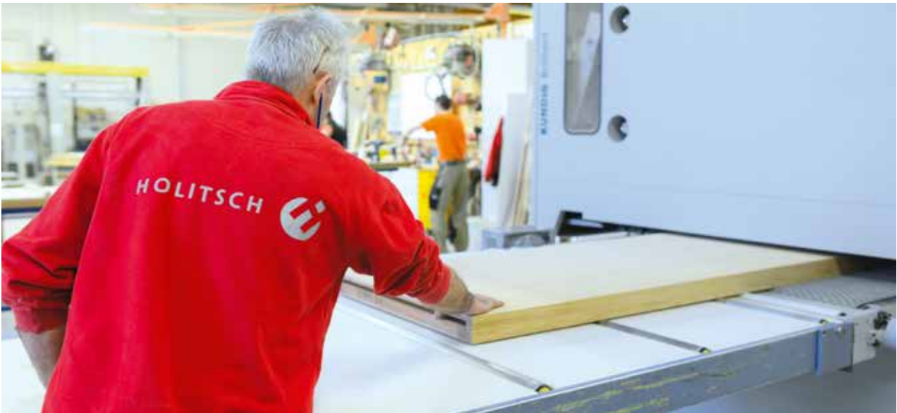
Bei Holitsch kommt der Kündig Brilliant-4 1350-REEdH-L inzwischen eine Schlüsselrolle zu. Von schweren Kalibrierarbeiten bis zum feinsten Hochglanz-Lackschliff sei sie universell verwendbar und ermögliche sogar neuartige Oberflächen.
