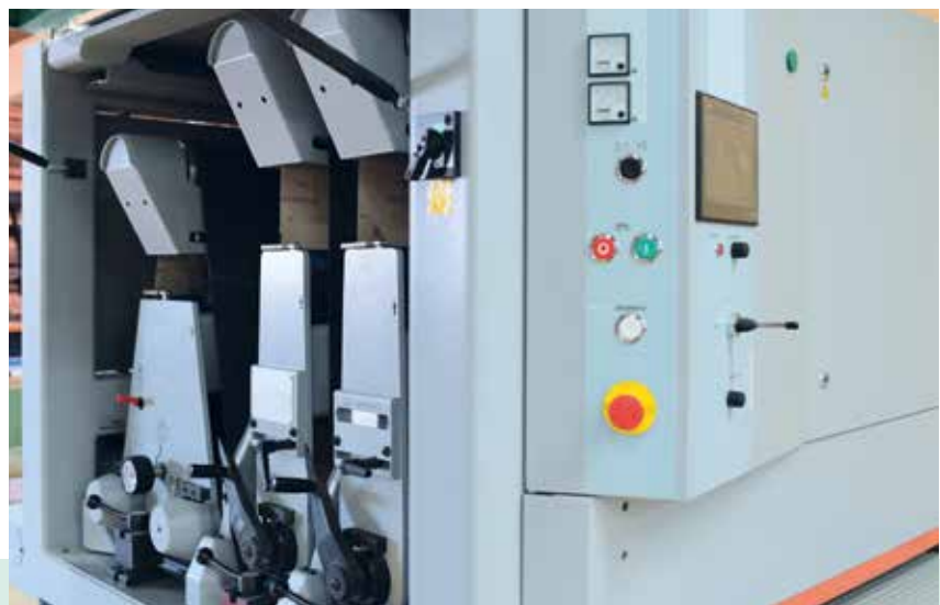
Zwei Walzenaggregate und ein Pneumatikschleifschuh ermöglichen mit bis zu einem Millimeter Abtrag pro Durchgang ein zügiges Kalibrieren.
