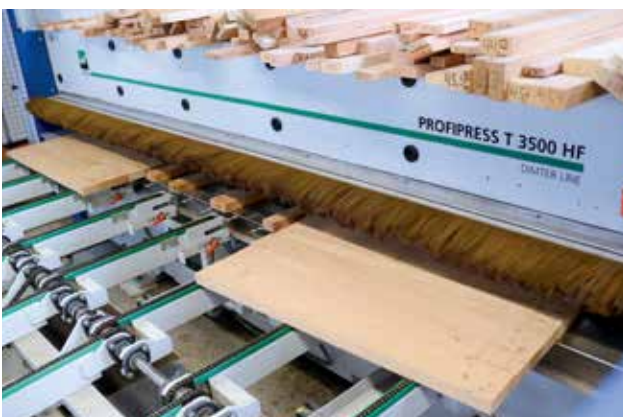
Verleimt wird mit Hochfrequenz. Danach werden die Platten, so wie sie aus der Presse kommen, bis zur fertigen Oberfläche geschliffen.
