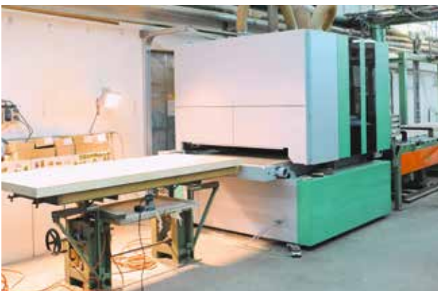
Die Kündig Brilliant wird bei Moralt in der laufenden Linie zwischen Längs- und Querschleifen umgeschaltet.
