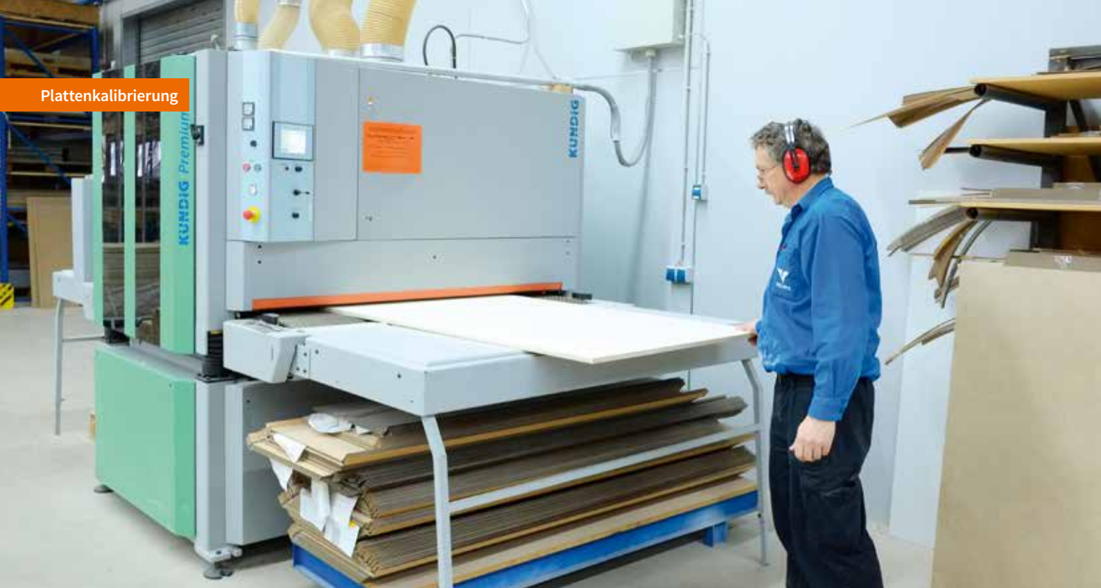
Die Kündig Premium-2 1600-RR beim Schienenfahrzeug-Spezialisten Volante kann mit ihrer serienmäßigen Arbeitsbreite von 1600 mm ganze Plattenformate vor der Weiterverarbeitung kalibrieren.
