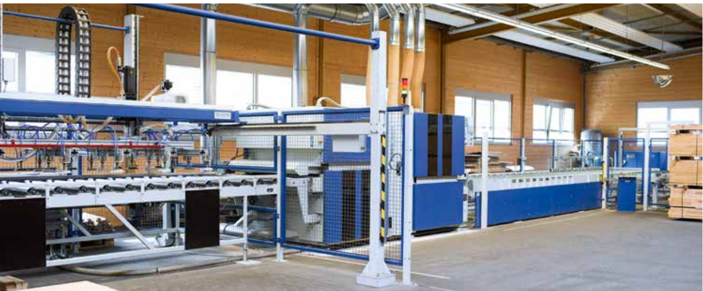
Ausnahmsweise nicht grün: Die Kündig Technic Botop-6 1350-RRP-RRP bei Laubholz-Plattenhersteller Ohnemus wurde für ein einheitliches Erscheinungsbild blau lackiert. Auch technisch ist die Hochleistungs-Schleifanlage nahtlos in die Produktionslinie integriert.
