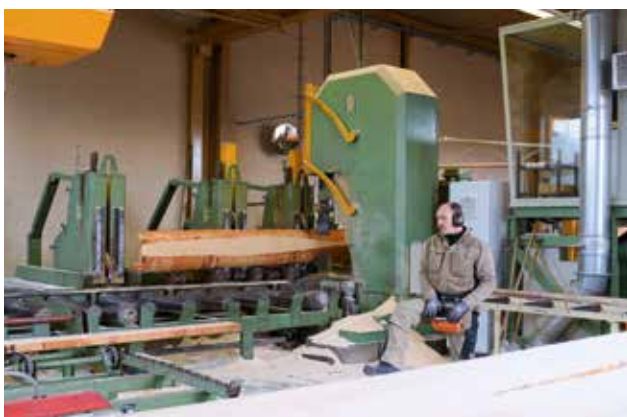
Der Einschnitt im Laubholzsägewerk Ohnemus erfolgt präzise mit einer modernen Blockbandsäge.
