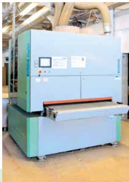
Diese Kündig Duplex mit Diagonalaggregat schleift seit zehn Jahren verlässlich.
