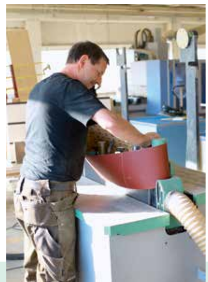
Auch die Kündig Uniq Kantenschleifmaschine hat sich bewährt.
