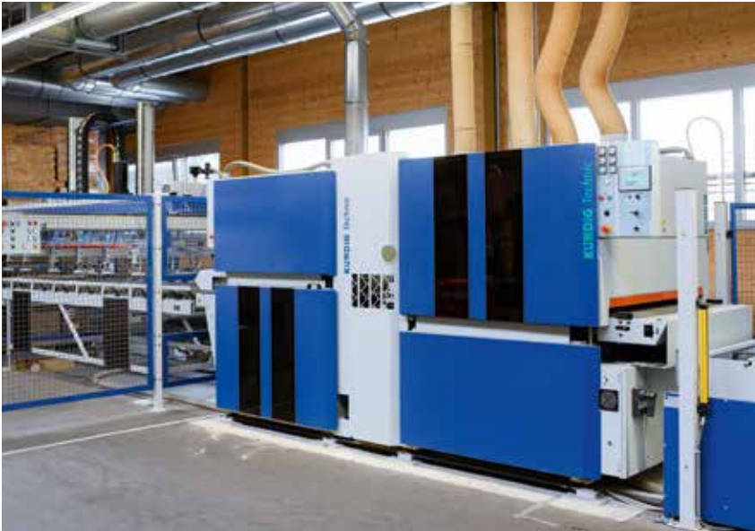
Mit sechs oben- und unten schleifenden Aggregaten kann die Anlage in nur einem Arbeitsgang Massivholzplatten mit fertiger Oberfläche herstellen.
