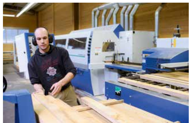
Die zweimalige Qualitätssortierung wird jeweils vor der Beschickung der Hobelanlage und der Verleimstation ausgeführt.
