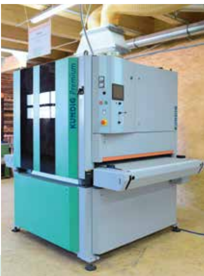
Die kompakte Kündig Premium wird auch mit schweren Platten mühelos fertig.
