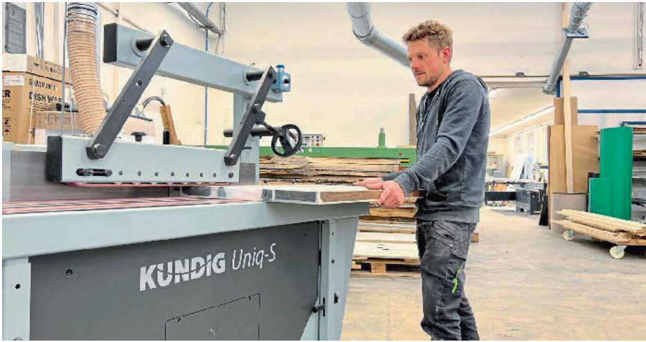
/ Auch für den anspruchsvollen und präzisen Kantenschliff ist Felix Osbelt bestens gerüstet. Hier setzt er auf eine Kündig Uniq-S, die über einen in den Maschinenkörper integrierten Vorschubapparat verfügt.
