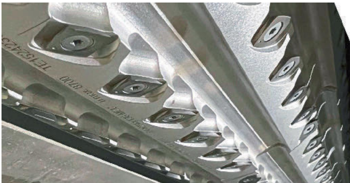
/ Bei der Hobelwelle handelt es sich um eine Oertli Castor Optimo, welche durch die in Nuten angebrachten Wendeschneidplatten ein sehr feines Hobelbild erzeugt.
