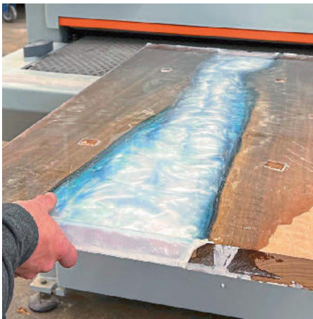
/ Typischer Fall für die Hobelwelle: Dieser Rivertable muss von überschüssigem Epoxidharz befreit werden.
